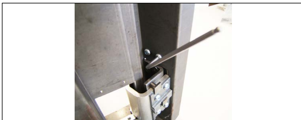
Fig. 22: Regolazione orizzontale in profondità - Depth horizontal adjustment
