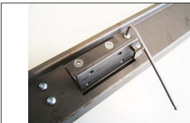
Fig. 17: Fissaggio del gruppo staffe al profilo anta – Plates fixing to the wing profile
