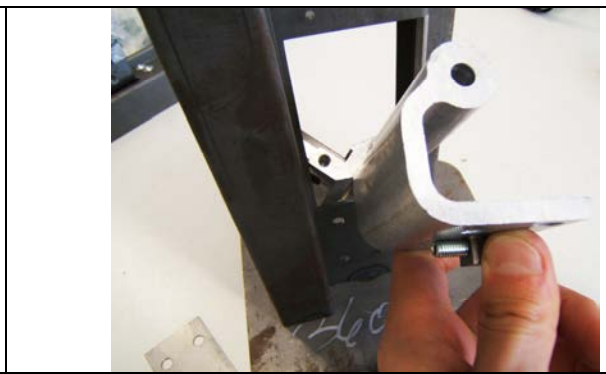
Fig. 14: Inserimento della cerniera con telaio montato – Hinge insert with assembled frame
