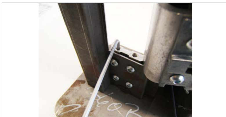
Fig. 20: Regolazione in altezza dell'anta - Vertical adjustment
