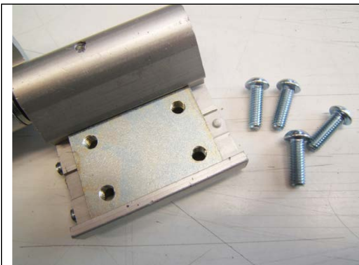
Fig. 11: Inserimento della staffa rettangolare nella cava del corpo inferiore – Insert rectangular plate in the space lower body
